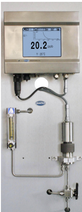
Bild 3: Die optische Sauerstoffmessung K1100 ist die neueste Entwicklung für Kraftwerksanwendungen
